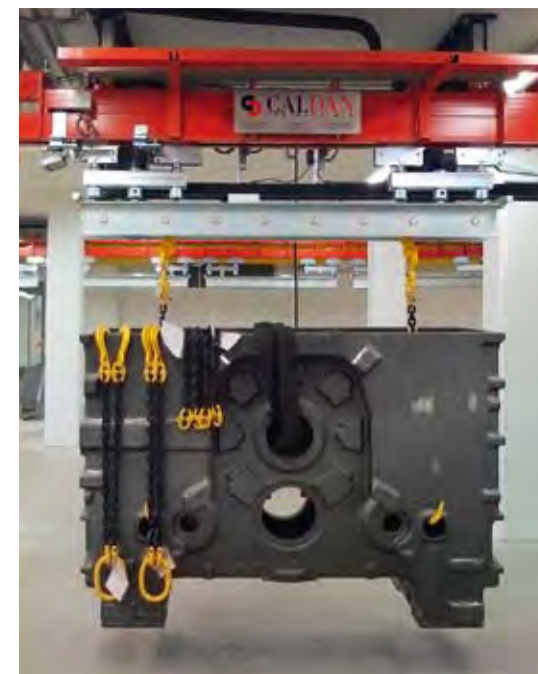
Des rails imposants acheminent des pièces jusqu'à 2,5 tonnes à travers l'installation de thermolaquage.
