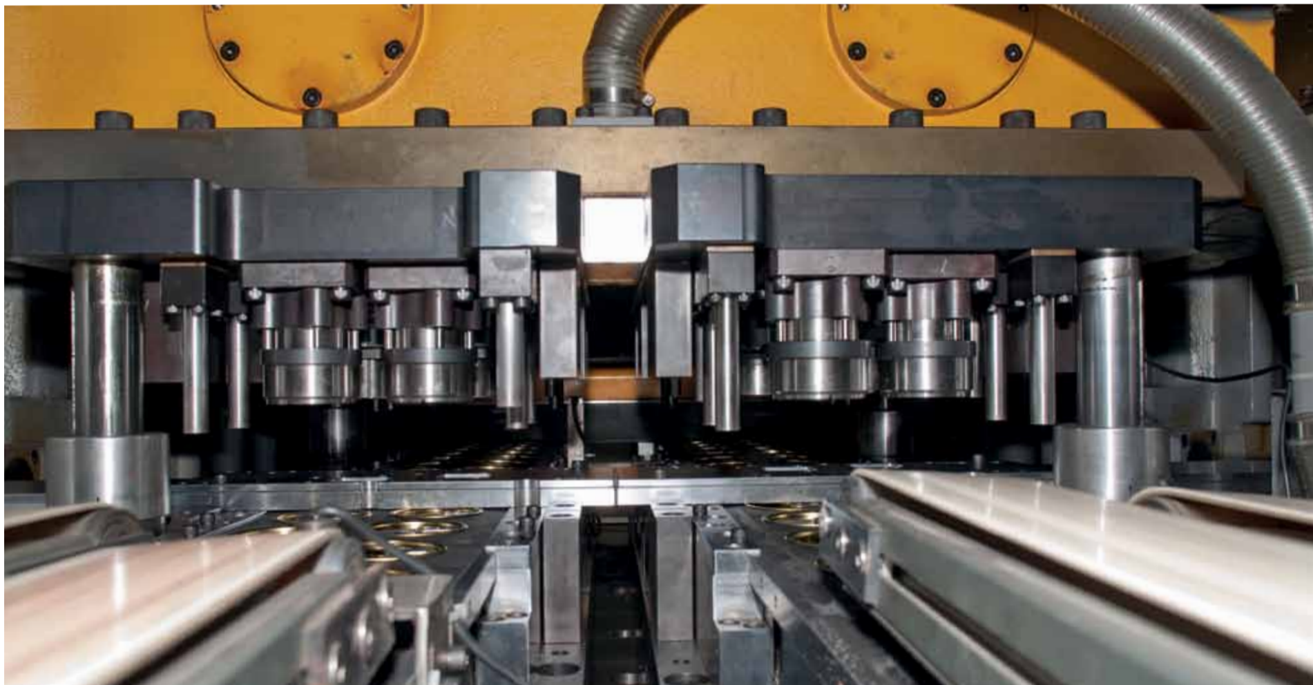
Des Easy Open Ends terminés sont acheminés vers la BSTA 1250-117 pour la prochaine étape de production.
