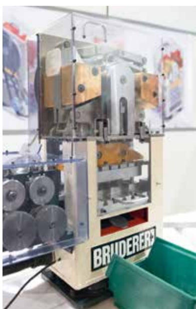
Die BRUDERER Lernenden konnten an der OBA mit einem selbst konstruierten und gefertigten Miniatur-Stanzautomaten überzeugen.
