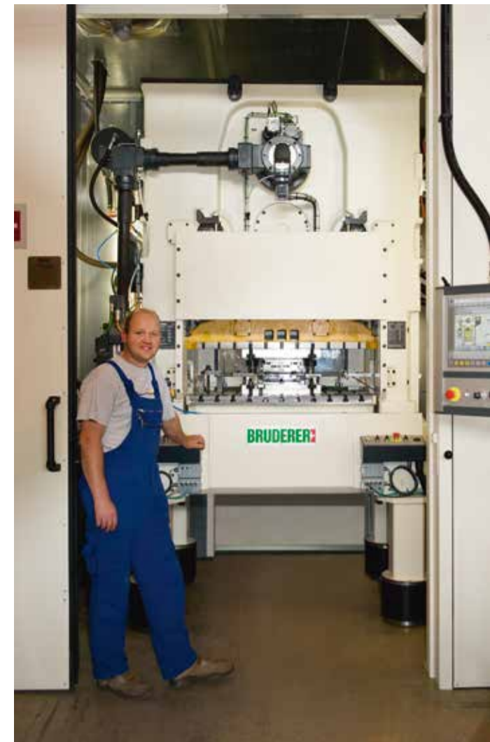
Mit Stolz an der Arbeit. Ronny Intreß vor dem neuen Hochleistungs-Stanzautomaten BSTA 280-88 mit B2 Steuerung.
