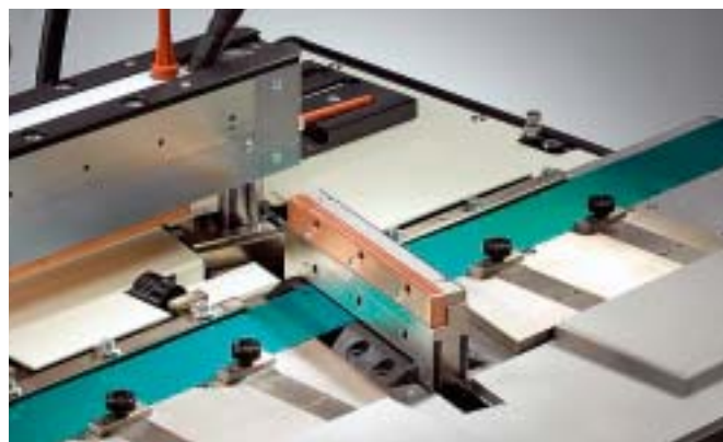
Die Schweissnaht hält: höchste Ansprüche unterschiedlichster und schwierigster Umformprozesse // Hydraulisches Trennen der pneumatisch gespannten Bandenden // Motorischer Vorschub des Brenners beim Schweissvorgang //
