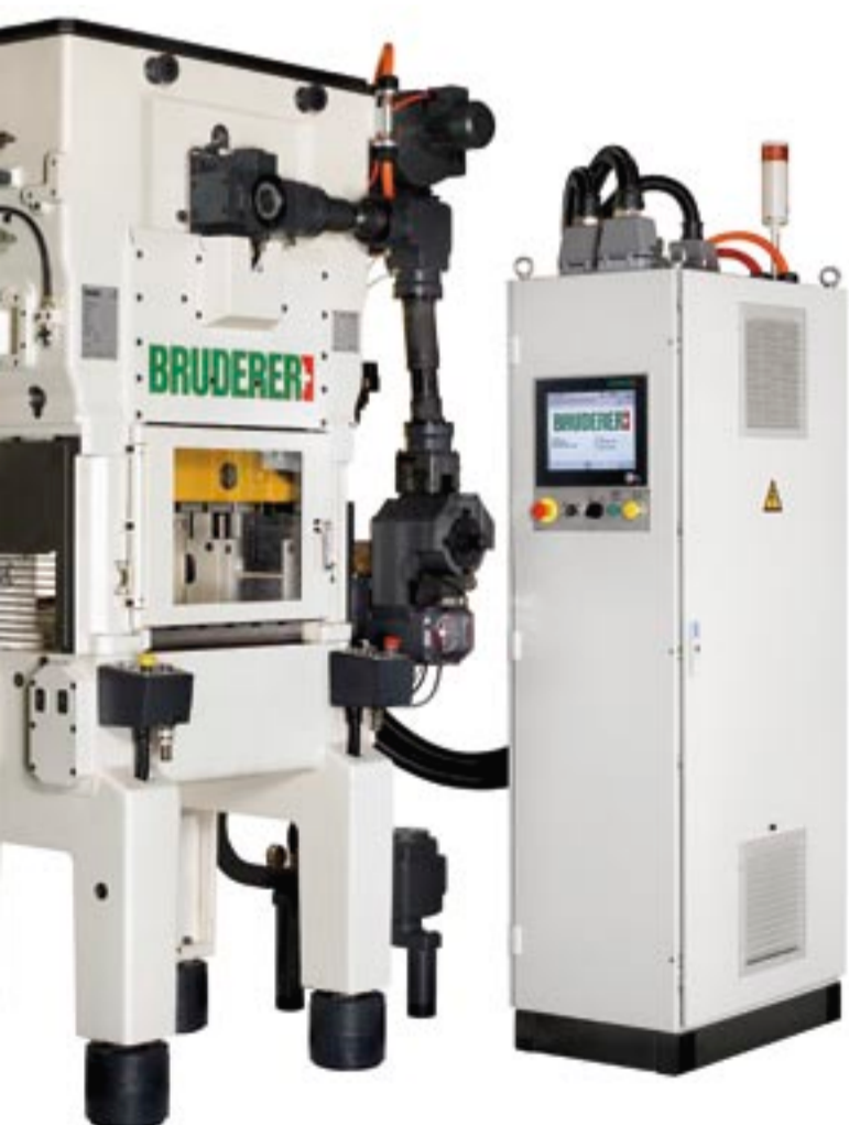
Stanzautomat BSTA 200-60BE in Verbindung mit der Maschinensteuerung B-Essential als platzsparende Einschranklösung 50 x 80 x 190 cm (B x T x H)
