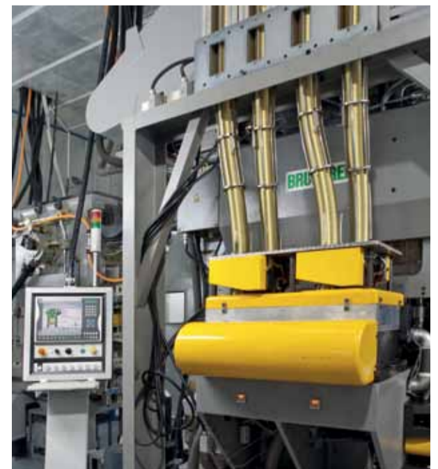
Die aufgestapelten Deckel werden für die Verbindung mit den Laschen dem BSTA 1250-117 zugeführt.
