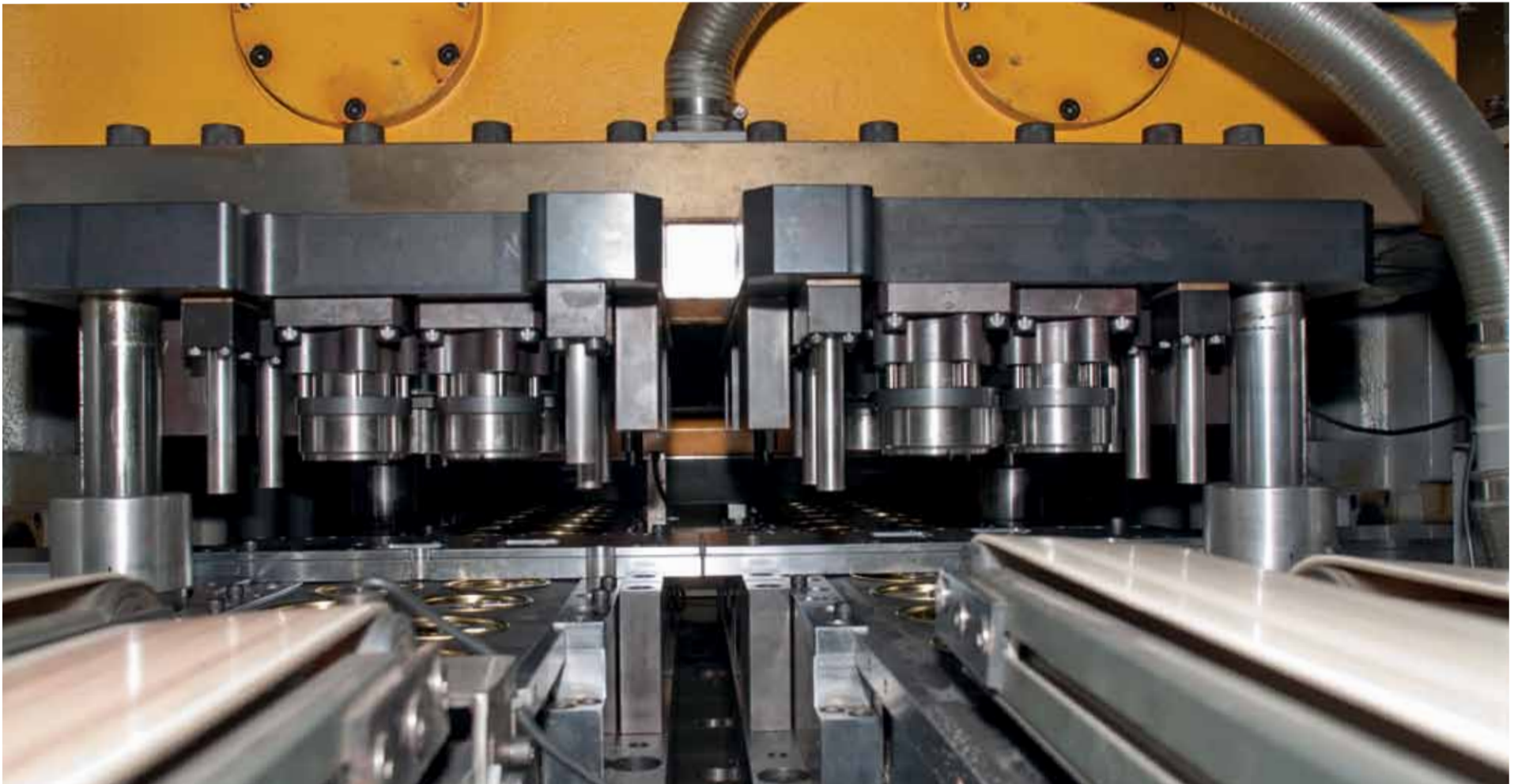
Fertige Easy Open Ends auf dem Weg zum nächsten Fertigungsschritt auf dem BSTA 1250-117.
