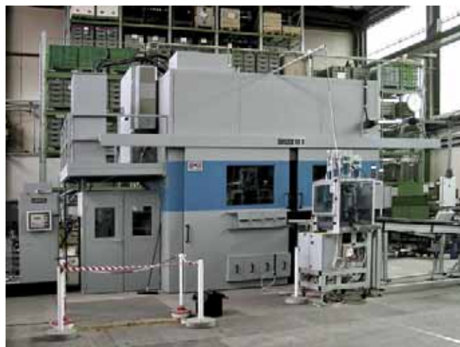
Gesellschaft für Lärmbekämpfung mbH – Individuelle Schallschutzmassnahmen nach Kundenwünschen: Fertigungsanlage bei Fa. Miele
