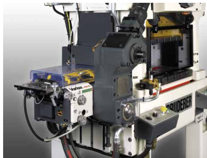
Zangenvorschub VGB 30 - angebaut an einen Hochleistungs-Stanzautomaten der Baureihe BSTA 250
