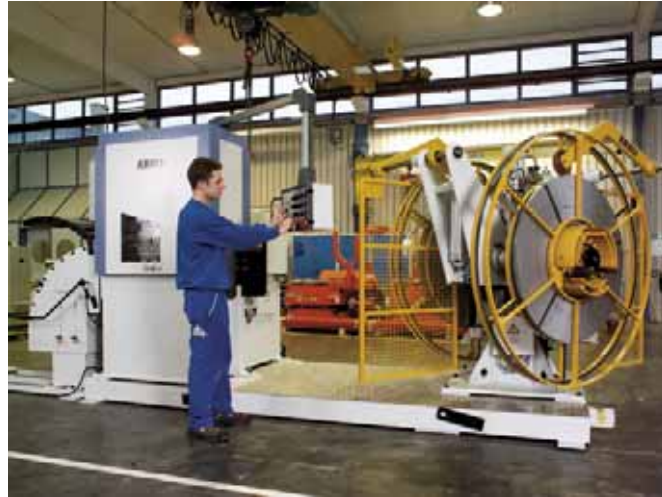
Optimale Richtergebnisse und hohe Verfügbarkeit: Präzisions-Richtmaschine in Kombination mit einer Doppel-Wendehaspel
