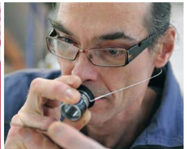
Mit einer Lupe kommt Stanzereileiter Marc Maradan selbst kleinsten Gaten an Mikrobauteilen auf die Spur.
