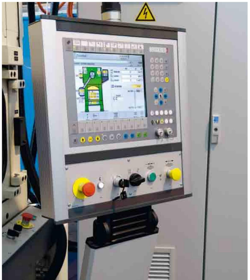
Bedienpanel der B2-Steuerung mit Touch-Screen: handlich zu bedienen und platzsparend.
