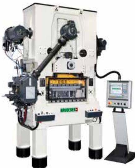
BRUDERER 翻新机的样本 - 一台 BSTA 50R-95 冲床，配置 B2 控制系统和 BBV 202/120 的辊式送料机
