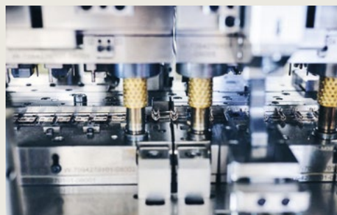
Fase 1 Il materiale per realizzare il contatto viene tranciato e piegato nella forma desiderata.
