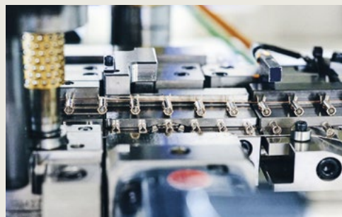
Fase 2 La molla viene inserita all'interno del contatto direttamente nello stampo durante la tranciatura.
