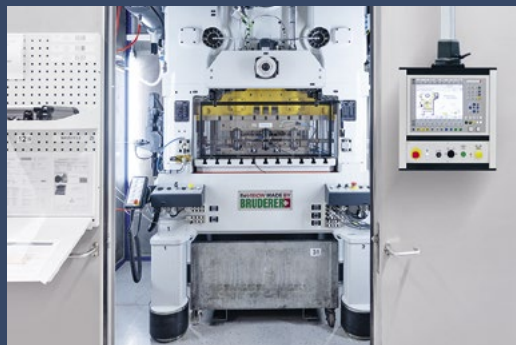
Come nuova: grazie al retrofit, questa BRUDERER BSTA 50 soddisfa tutte le più moderne esigenze di Hirschmann Automotive Freyung GmbH.
