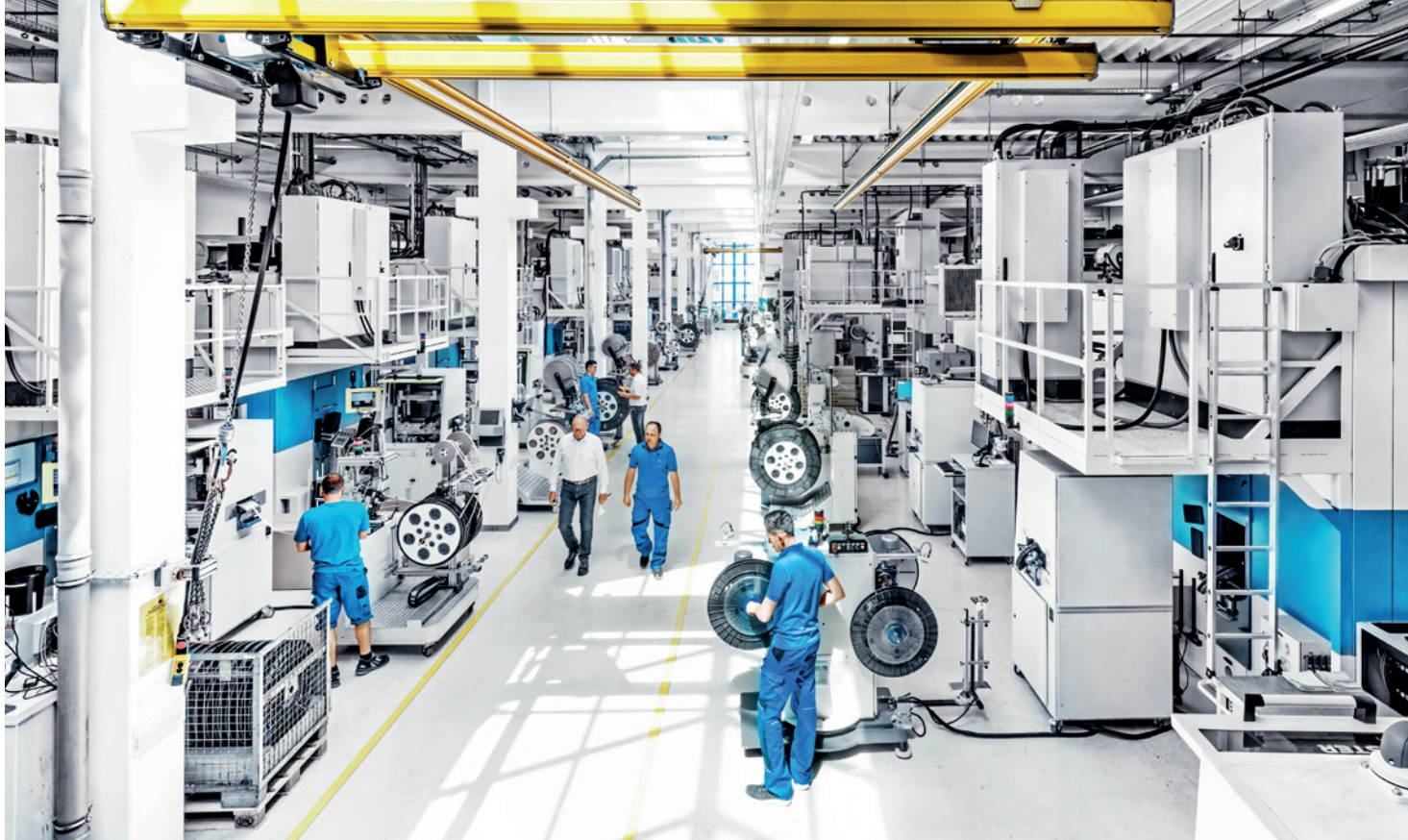
L'atelier de découpage avec ses 22 presses BRUDERER d'une capacité comprise entre 25 et 80 tonnes.
