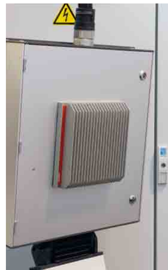
La commande est refroidie à l'arrière du boîtier, le ventilateur n'est plus nécessaire.
