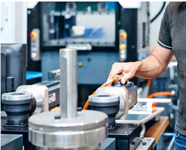
プログラム可能な回転ステーションにより、さまざまな形状の積層スタックを製造できます。
