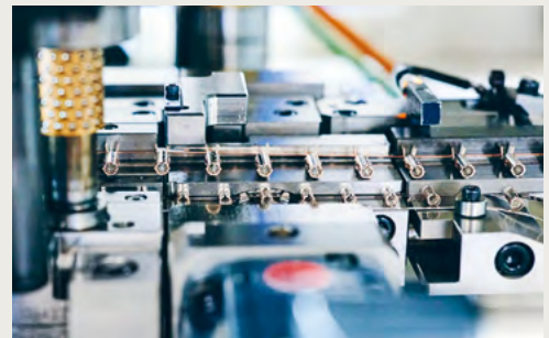
ステップ2 プラグ接点には、スタンピングプレス内で直接追加された内部スプリングがあります。
