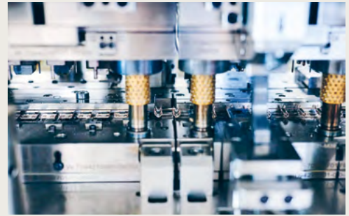
ステップ1 プラグ接点の材料は、必要に応じて打ち抜かれ、成形されます。
