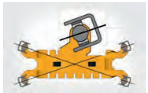
热平衡的滑块导向装置补偿水平方向上的热变形
